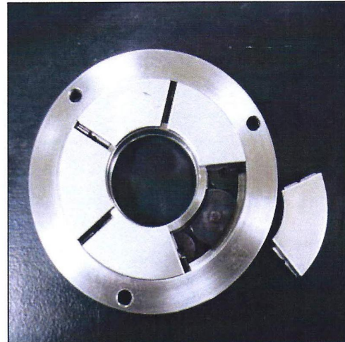
TURBINE TILTING PAD THRUST BEARING (원자력, 화력 터빈 발전기 스러스트 베어링)
