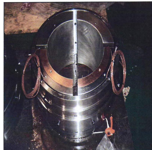
TILTING PAD RADIAL JOURNAL BEARING (영광1발전소 고압터빈 #1,2 베어링) (온도 20° 감소, 진동 63/㎍ 감소)
